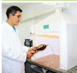
**A Clean possui Laboratório Acreditado NBR ISO/IEC 17025** para calibração de detectores de gases fixos e portáteis
