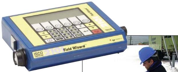
*Um módulo à prova de intempéries para recuperação dos dados no local de medição.*
