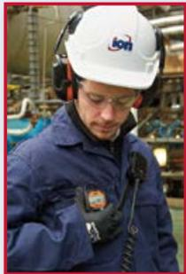
Se o CUB<sup>TAC</sup> der algum sinal de alarme, significa que o TAC está ultrapassando 1 ppm\*\*, indicando que as concentrações de benzeno podem estar acima de níveis seguros.
